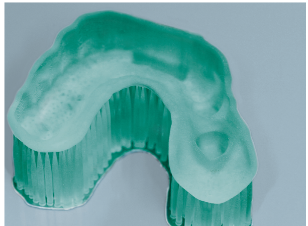
Abb. 4 individuelle Löffel, gedruckt aus Freeprint® tray UV
