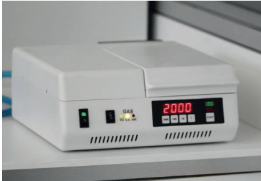
Abb. 2 Otoflash G171 – Nachbelichtung 2000 Blitze
