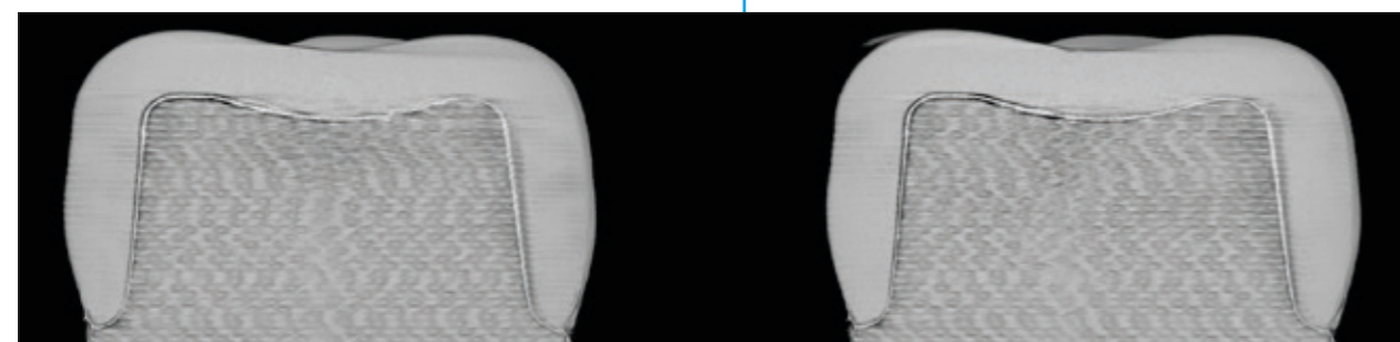
Figura 11: immagine comparativa ottenuta mediante microtomografia a raggi X \mu CT (sezione) di una corona cementata prima (a sinistra) e dopo (a destra) la simulazione della masticazione
