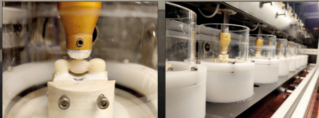
Figure 6 e 7: struttura della prova di simulazione della masticazione per i ponti provvisori a lungo termine
