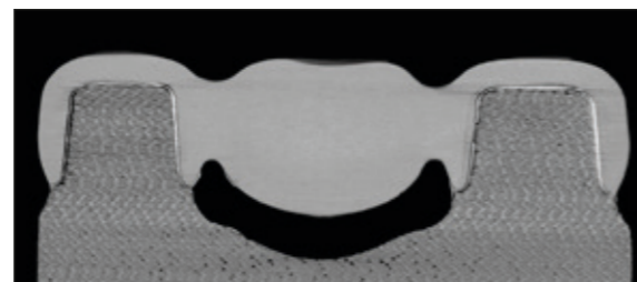
Figura 10: immagine (sezione) del ponte cementato, ottenuta mediante microtomografia a raggi X \mu CT, dopo la simulazione della masticazione
