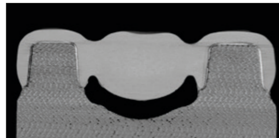
Figure 10 : Image \mu CT (coupe) du bridge scellé après la simulation de mastication
