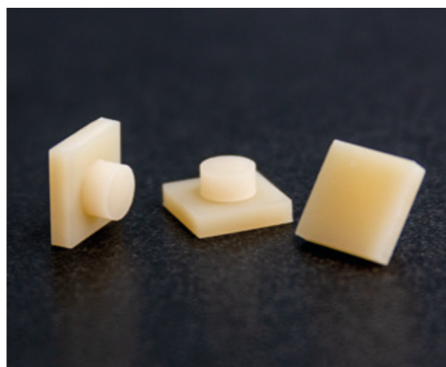
Figure 13 : Éprouvettes pour la détermination de la résistance de la liaison
