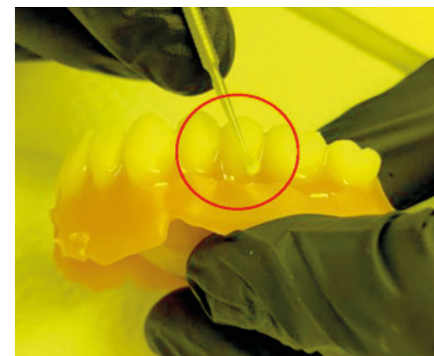
Figure 17 : Élimination de l'excédent à l'aide d'un pinceau
