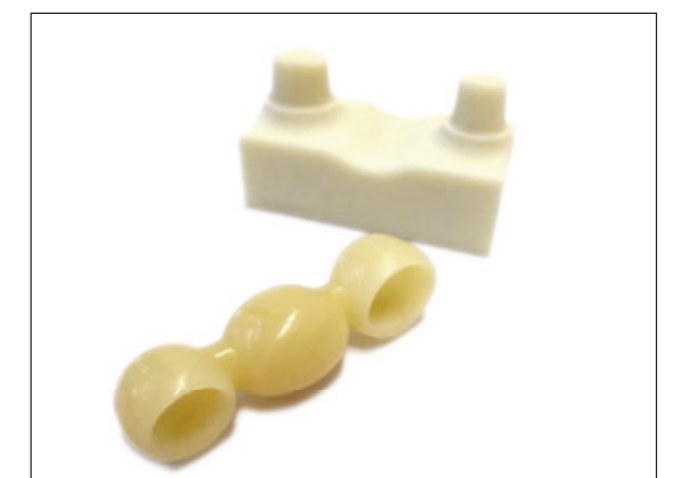
Figure 8 : Géométrie de l'éprouvette pour la simulation de mastication
